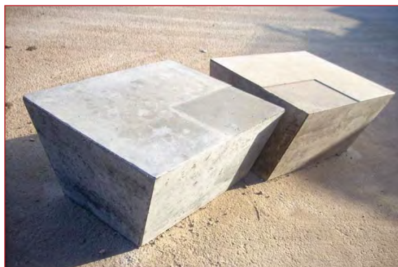
Figura 8.4. Banco de hormigón fabricado con áridos reciclados.
