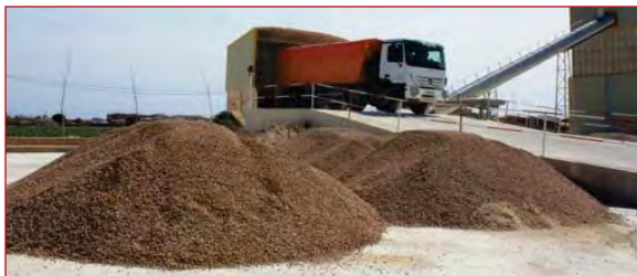
Figura 8.46. Acopio de áridos reciclados mixtos.
