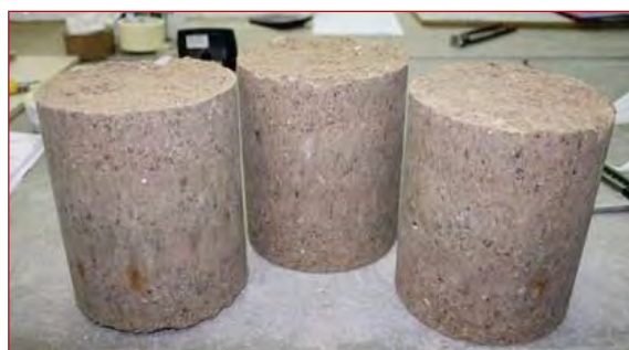
Figura 7.16. Probetas de suelocemento antes de su rotura – Serie I.
