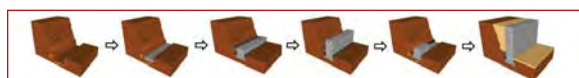
Figura 8.23. Esquema de ejecución del muro construido a partir de bloques prefabricados con árido reciclado.
