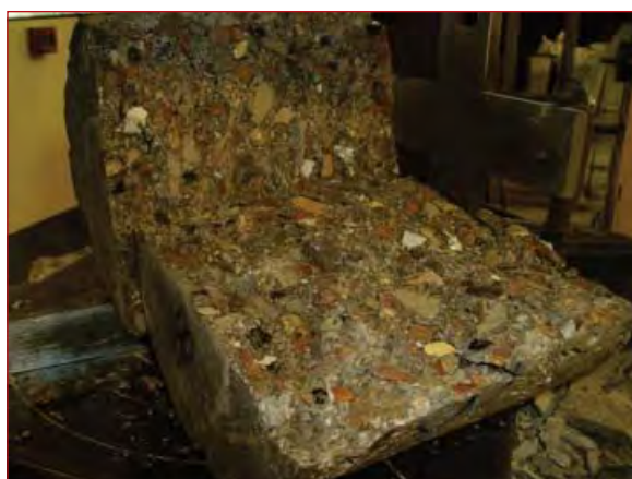
Figura 8.38. Ensayo de tracción indirecta para HRCR con ARMh.
