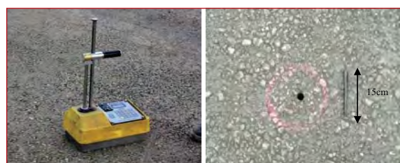
Figura 8.60. Medida de la densidad in situ.
