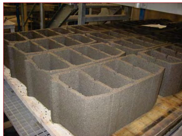
Figura 8.8. Bovedilla fabricada con áridos reciclados con un contenido mayoritario de residuos de hormigón.
