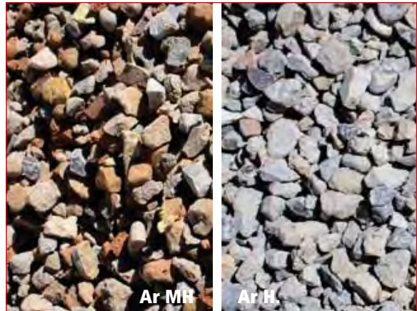
Figura 8.47. Aspecto de los áridos reciclados mixtos y áridos reciclados de hormigón.
