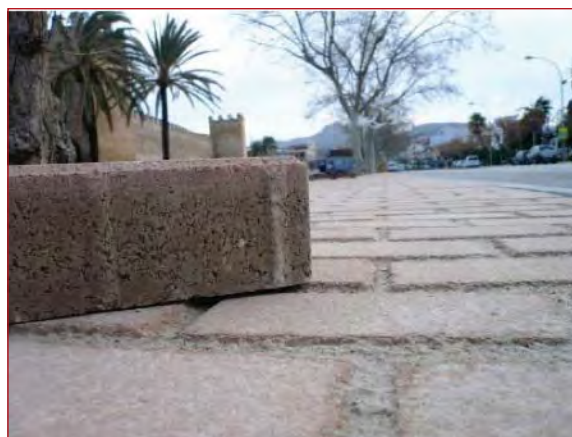
Figura 8.5. Adoquín fabricado a partir de árido reciclado por la empresa Pastor, S.A.
