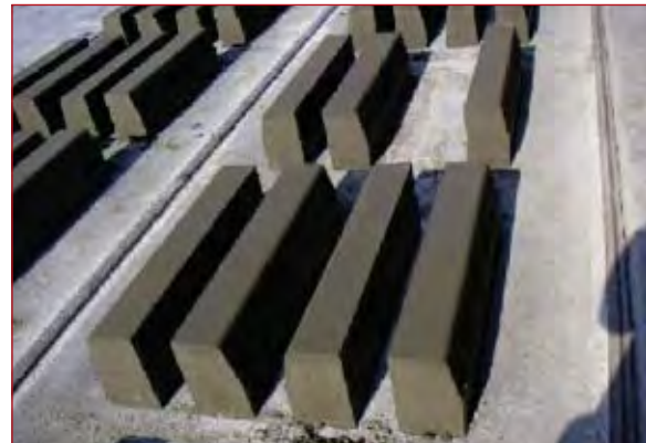
Figura 8.3. Bordillos fabricados a partir de áridos reciclados.
