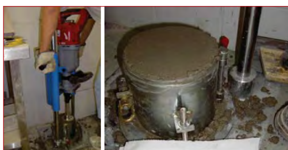
Figura 8.35. Fabricación de probetas en laboratorio con el Kangoo, simulando la técnica para HCR.
