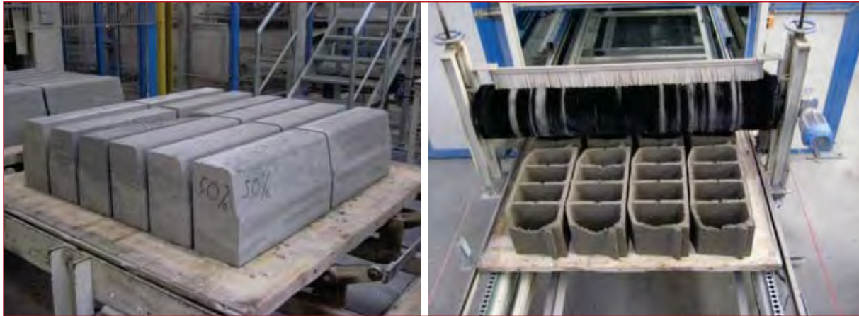
Figura 8.15. Bordillos y bovedillas saliendo del proceso de fabricación.
