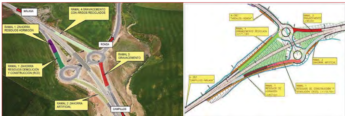
Figura 7.9. Tramos experimentales con materiales reciclados de RCD's de la obra "Conexión de la A-367 (Ardales-Ronda) con la A-357 (Campillos-Málaga).
