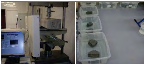
Figura 8.18. Ensayo de resistencia a flexión (izquierda) y ensayo de absorción de agua (derecha) ambos realizados sobre el bordillo.
