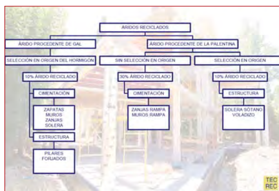
Figura 8.70. Esquema de la grava reciclada utilizada en el Proyecto Tato 14.
